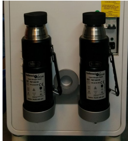
Figura 13: Recipientes de almacenamiento para termos Dewar - la forma correcta de colocar los termos Dewar en el estante de almacenamiento.
