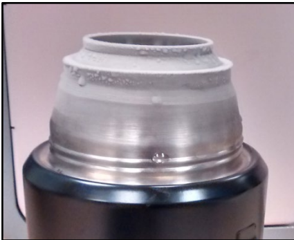
Figura 27: Escarcha en la boca del termo Dewar
