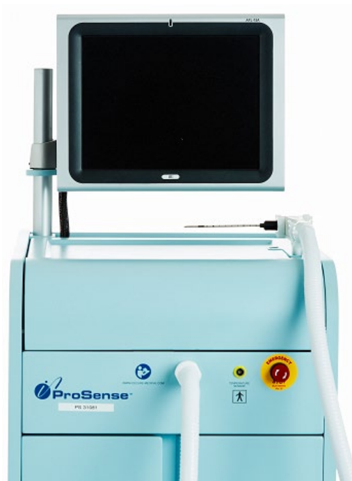
Figura 88: Botón de parada de emergencia ubicado en el chasis principal
