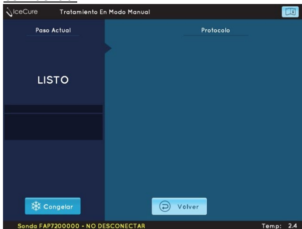
Figura 57: pantalla de Modo manual: pulse Congelar para iniciar el paso de congelamiento.
