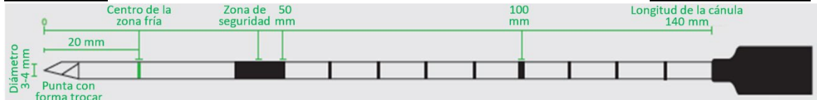
Figura 54: ilustración de la criosonda FAP7200000 que muestra las marcas en la criosonda
