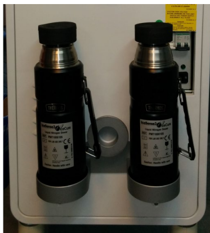
Figura 13: caixas de armazenamento de Dewar - a forma correta de colocar os Dewars dentro da prateleira de armazenamento.
