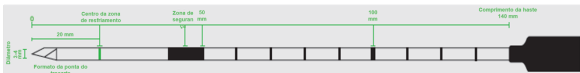
Figura 54: ilustração das marcações de criossonda FAP7200000 na criossonda.
