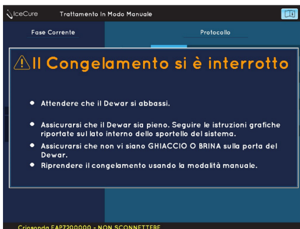
Figura 80: Messaggio per la sostituzione del vaso di Dewar vuoto durante il ciclo di Congelamento.
