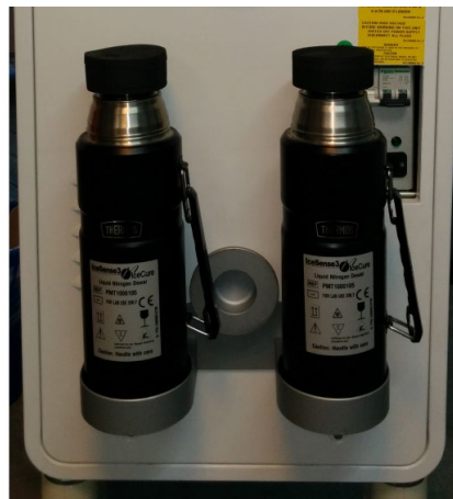
Figura 13: Alloggiamenti per i vasi di Dewar; modo corretto di inserire i Dewar all'interno degli alloggiamenti.
