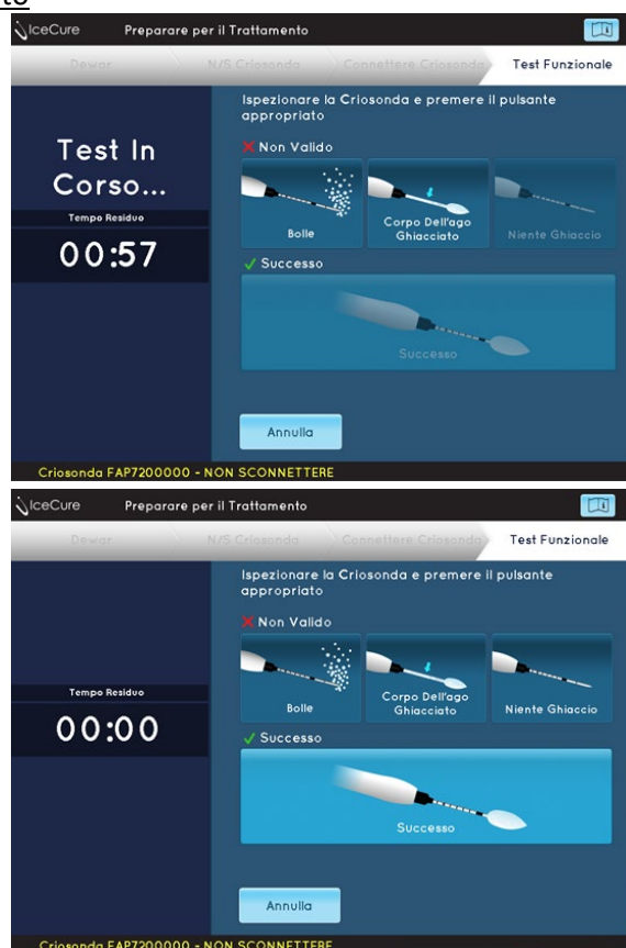
Figura 41: Test funzionale - Schermate di ispezione visiva
