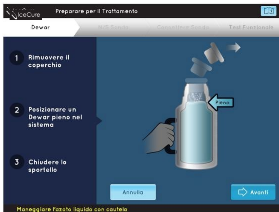
Figura 26: Schermata di preparazione del vaso di Dewar
