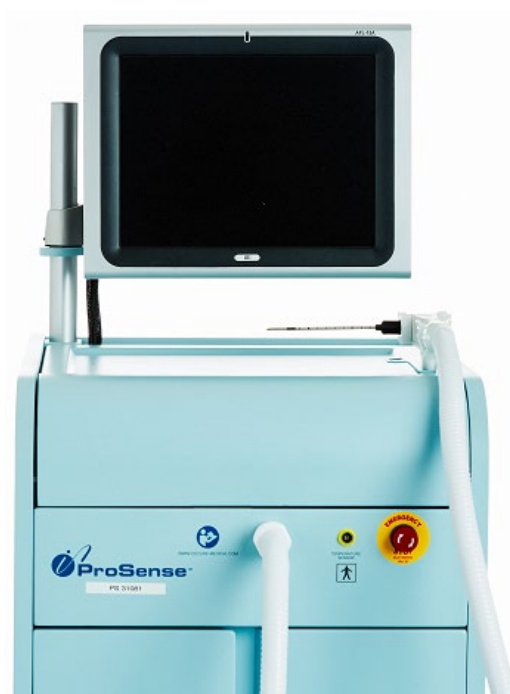
Figura 88: Pulsante di arresto di emergenza situato sulla struttura principale
