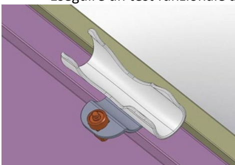
Figura 8: Supporto per lo spinotto del manipolo e spinotto del manipolo.
