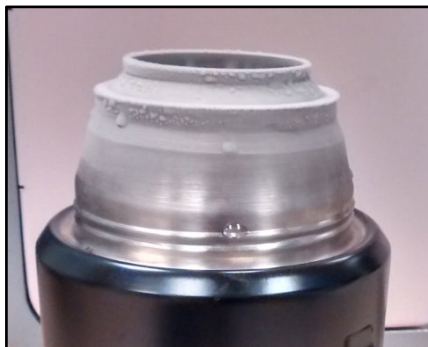
Figura 27: Formazione di gelo sull'imboccatura del Dewar
