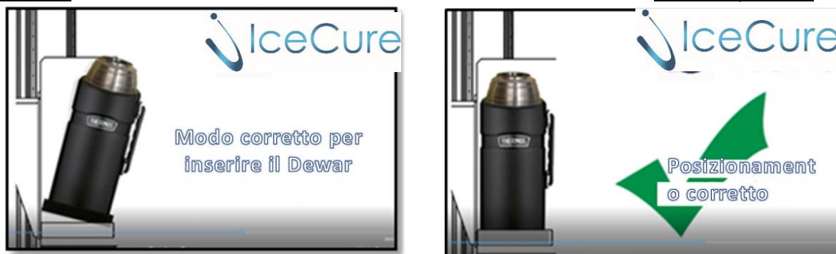
Figura 29: Inserimento e posizionamento corretti del vaso di Dewar – Fondo per primo
