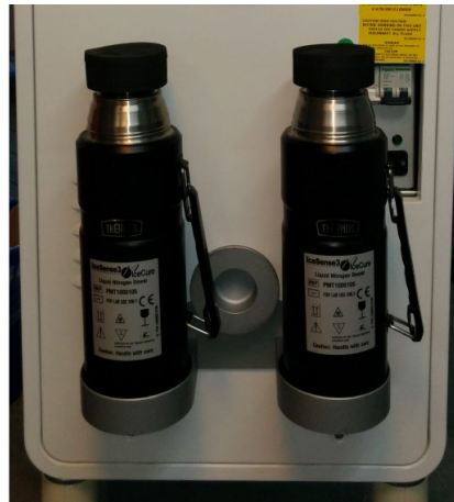
Abbildung 13: Aufbewahrungsfächer für die Dewargefäße – die richtige Methode zum Einsetzen der Dewargefäße in das Aufbewahrungsfach.
