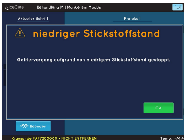
Abbildung 81: Eingriff aufgrund des niedrigen Flüssigstickstofffüllstands abgebrochen.
