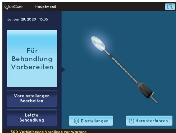
Abbildung 25: Vorbereitung des Systems für die Behandlung durch Betätigen der Schaltfläche „Prepare for Treatment“ („Für Behandlung vorbereiten“) im Hauptmenübildschirm
