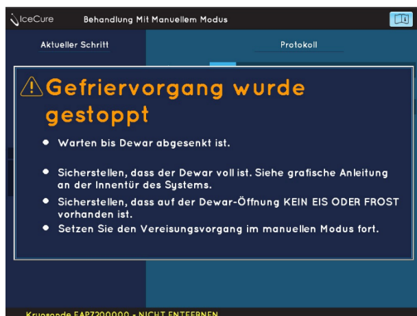
Abbildung 80: Austausch während des Vereisungsvorgangs bei leerem Dewargefäß.
