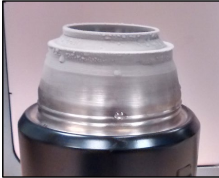
Abbildung 27: Eisbildung an der Öffnung des Dewargefäßes
