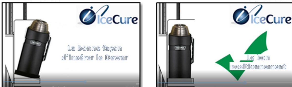
Figure 29 : insertion et positionnement corrects du dewar – bas en premier
