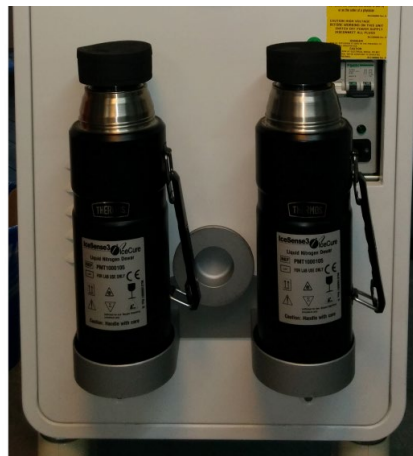
Figure 13 : Casiers de stockage des vases Dewar - La bonne façon de placer les dewars sur l'étagère de stockage.
