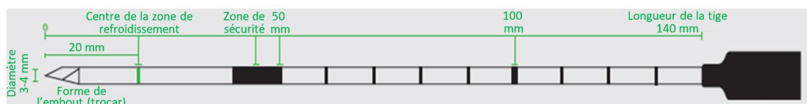
Figure 53 : illustration des repères de la crysonde FAP7200000.
