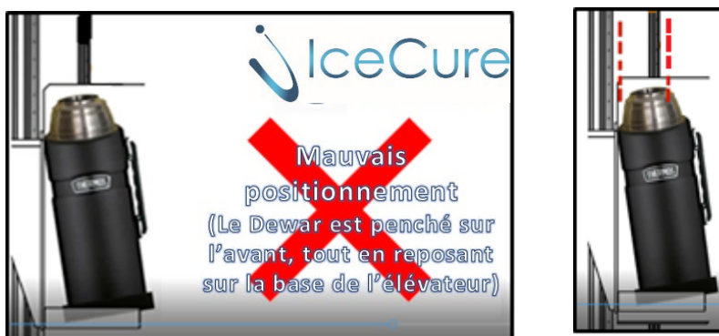
Figure 30 : insertion du Dewar – tête en premier, incliné sur l'avant
