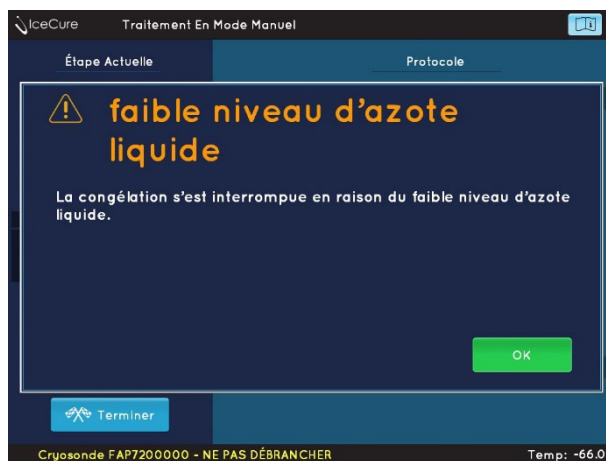
Figure 80 : l'intervention s'est arrêtée en raison d'un faible niveau de liquide azote.
